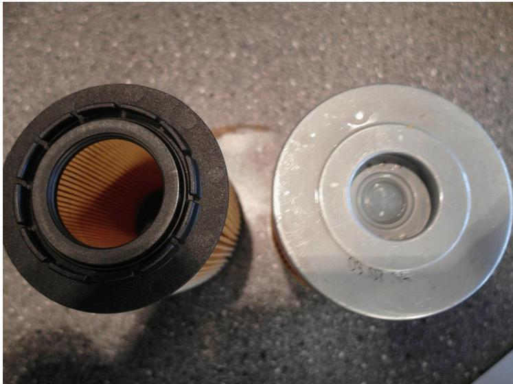
sowie der **Filtergehäusedeckel links (für den OX160D)** und der **Filtergehäusedeckel rechts (für den OX125)**
